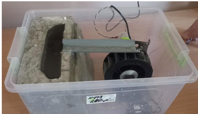
Рисунок 1. Фото макету гідроелектростанції на принципі гребного колеса
